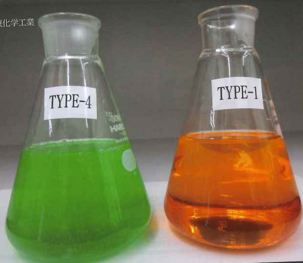
●関東化学工業製 ADF の Type - IV (防雪氷用) と Type - I (除雪氷用)。従来 ADF は無色だったが、国際規格の改訂で有色 ADF となる予定 (来冬季より供給開始)。
